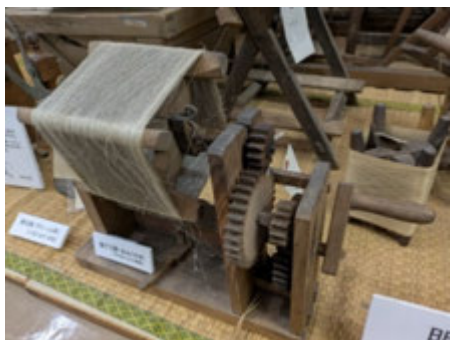
歯車の組合せに特徴がある上州座繰り器 小枠に巻きとられた糸は小枠ごと製糸組 合に持ち込まれました
